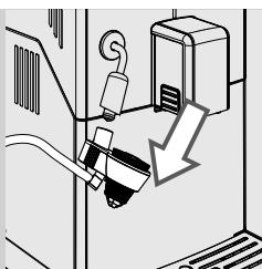
**2** Снимите автоматический вспениватель молока с трубы пара/горячей воды.
