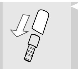
**18** Снимите всасывающую трубку.
