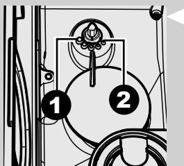
**3** Отметки, имеющиеся внутри емкости для кофе в зернах, указывают заданную степень помола. Можно выбрать 5 различных степеней помола, начиная с положения 1 (●) для крупного помола и более легкого вкуса, и заканчивая положением 2 (◐) для мелкого помола и более насыщенного вкуса. Если кофе водянистый или медленно выходит, измените настройки кофемолки.
