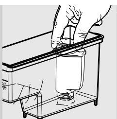
**4** Вставьте фильтр для воды «INTENZA +» в пустой бак для воды. Сдвиньте его как можно ниже.
