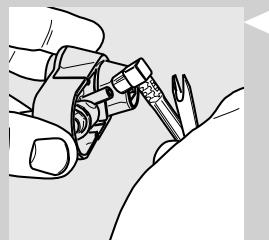
**19** Чтобы снять автоматический вспениватель молока, надавите на него с двух сторон и достаньте, слегка сдвигая его вбок, как показано на рисунке.
