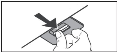
El filtro activo de carbón no se puede limpiar ni renovar y tiene que ser reemplazado aproximadamente cada 4 meses de uso o con mas frecuencia si se lo usa de una forma muy intensa.
