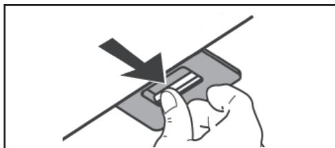
I filtri al carbone attivo non sono lavabili e non possono essere rigenerati, devono essere sostituiti approssimativamente ogni 4 mesi, o più frequentemente secondo l'uso.
