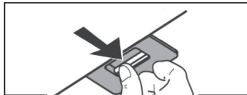
фильтр деревянного угля не подходит для очистки, не может быть обновлен, а должен заменяться приблизительно каждые 4 месяца использования или чаще в случае интенсивного использования.
