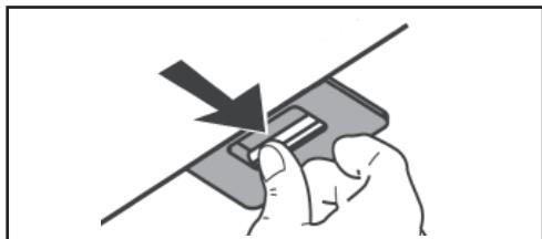
Le filtre à charbon de bois activé ne doit pas être nettoyé, est irrenouvelable et doit être remplacé tous les 4 mois d'utilisation ou plus souvent en cas d'utilisation particulièrement intensive.
