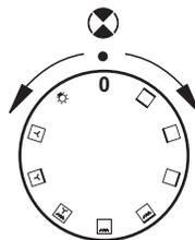
а также ручки регулирования температуры - установка заключается в повороте ручки на выбранное значение температуры
